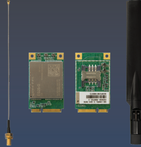
mPCIe LTE module kit Quectel 4G LTE CAT4 Global module EG-25G
